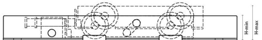
Ensaio de durabilidade, realizado em movimentos deslizantes de ida e volta, numa distância de 800 mm, num total de 25.000 ciclos.
